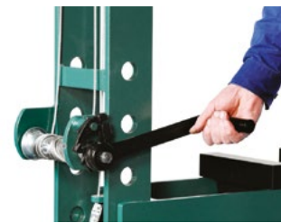
Regolazione rapida e sicura dell'altezza del bancale mediante una singola manovella frenata
