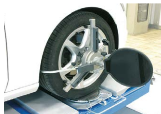
Messwertaufnehmer Target «Quickspanner»
