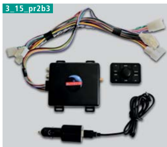
Fig. 3. Solution de post-équipement pour DAB+ avec unité de commande séparée.
