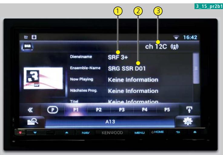
Fig. 1. Autoradio à double compartiment de Kenwood avec DAB+. 1 = Nom de la station («+» signifie qu'il s'agit de DAB+), 2 = Nom d'ensemble dans le réseau multiplexé D01 de la SRG SSR, 3 = Zone de réception 12C.
