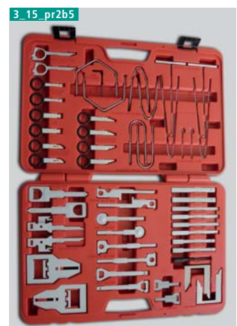
Fig. 5. Pour déposer les différents autoradios, il existe un kit de dépose spécifique. Ce kit ainsi que les autres solutions de post-équipement sont proposés, par exemple, sur www.caraudioshop.ch .
