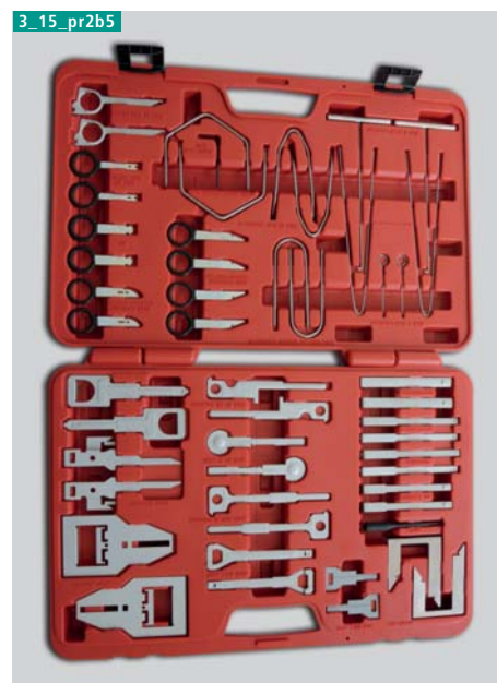
Bild 5. Für den Ausbau von verschiedenen Autoradios gibt es ein spezielles Ausbausset. Dieses, wie auch die anderen Nachrüstlösungen, sind zum Beispiel unter www.caraudioshop.ch erhältlich.
