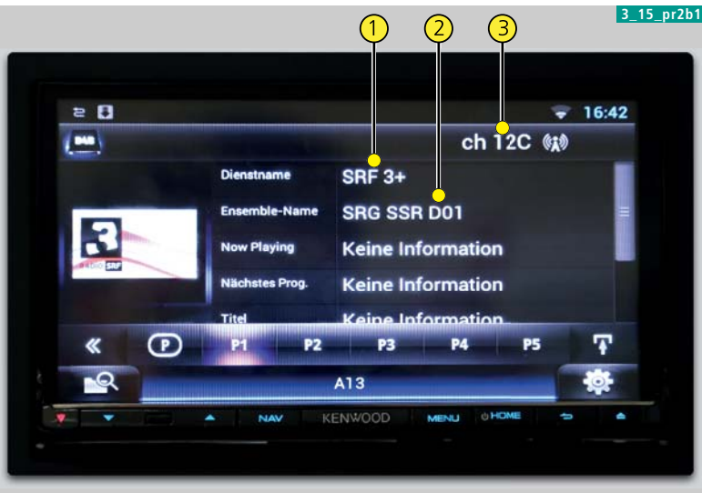
Bild 1. Doppel-DIN-Radio von Kenwood mit DAB+. 1 = Sendername (+ bedeutet, dass es sich um DAB+ handelt), 2 = Ensemble-Name im Multiplex D01 der SRG SSR, 3 = Empfangsgebiet 12C.
