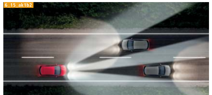
Bild 2. Beim Voll-LED-Scheinwerfer Opel IntelliLux-LED können bei Bedarf einzelne Sektoren weniger hell ausgeleuchtet werden.
