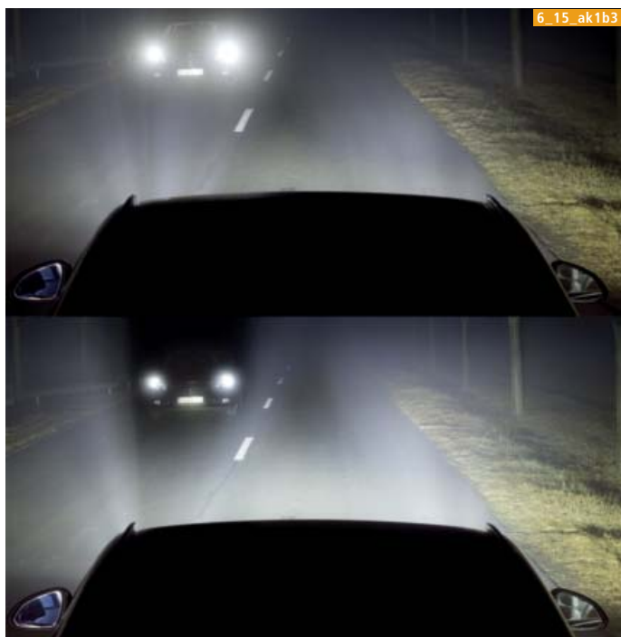
Bild 3. Entgegenkommender Verkehr: oben = Bi-Xenon-Fernlicht und unten = Opel IntelliLux-LED.
