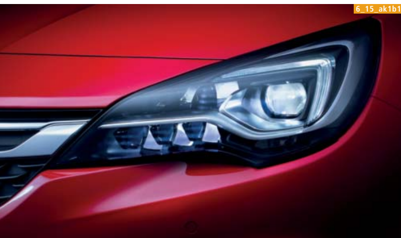
Bild 1. Die IntelliLux-Lichteinheit mit den acht LED-Arrays. (Bilder Opel)
