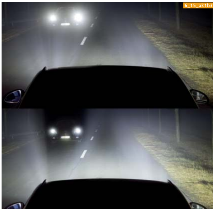
Fig. 3. Circulation en sens inverse: en haut = feux de route bi-xénon et en bas = Opel IntelliLux-LED.
