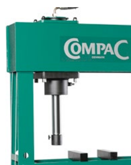
Seitwärts verschiebbarer Presszylinder
