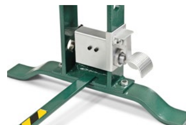
Sollevamento rapido del pistone con comando pneumatico a pedale (versione FP20/FP25)
