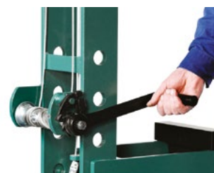
Regolazione rapida e sicura dell'altezza del bancale mediante una singola manovella frenata
